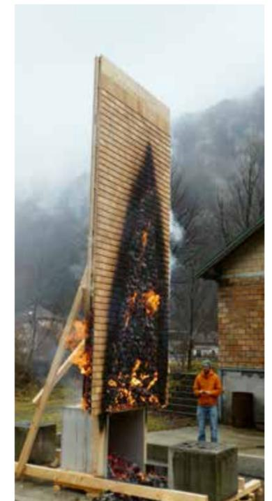
Nachdem die Stützflamme reduziert wurde, stagnierte die Ausbreitung des Feuers auf der Fassade.
