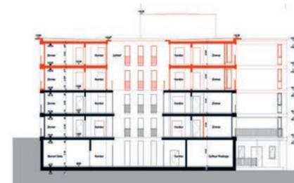
Querschnitt: In der Aufstockung wurde der Lichthof verbreitert, um mehr Licht in die Tiefe zu bringen.
