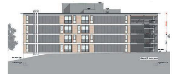
Nordfassade: Die Geschossübergänge sind mit einem Aluminiumband für den Brandschutz abgedeckt.
