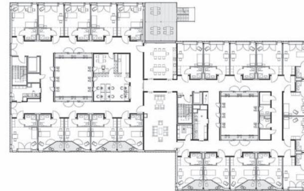
Grundriss 2. Obergeschoss mit identischem Zimmerraster wie der Bestand: Neu sind die Loggien zum Schallschutz an der Ostseite (unten im Bild).
