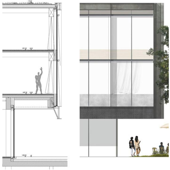
**Konstruktionsprinzip Fassade Pavillon**
