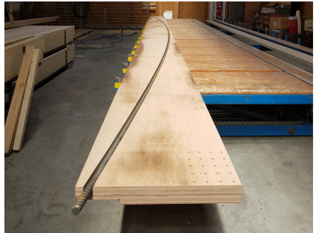
Im Detail: fischbauchförmig eingefräste Vorspannstange im Buchenträger
