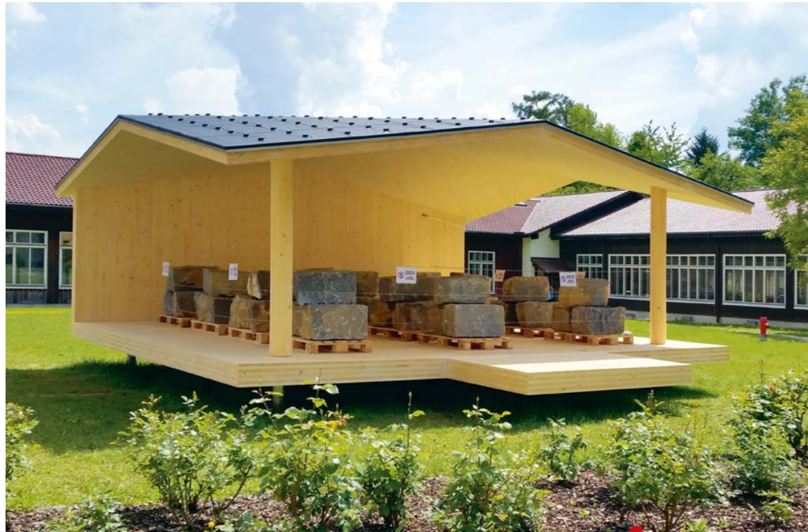
Der TS3-Langzeitprüfstand an der Berner Fachhochschule hat wichtige Resultate für die erfolgreiche Entwicklung der TS3-Technologien geliefert.
